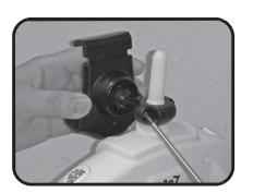
4. Schrauben Sie die Halterung des Smartphones sicher an der Radioantenne fest.
