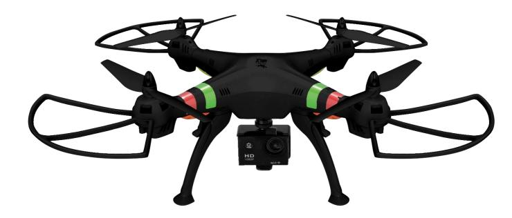
Die IND'FLY verfügt über vier installierte Propeller. Beachten Sie beim Ersatz der Propeller, dass jedes 4-er Set 2 Propeller enthält, die sich im Uhrzeigersinn drehen, und 2 Propeller, die sich entgegen dem Uhrzeigersinn drehen. Beachten Sie die hier dargestellte Abbildung beim Ersatz der Propeller: Die Propeller A auf den Armen der Drohne sind mit dem Buchstaben A gekennzeichnet, und die Propeller B auf den Armen der Drohne mit dem Buchstaben B.
